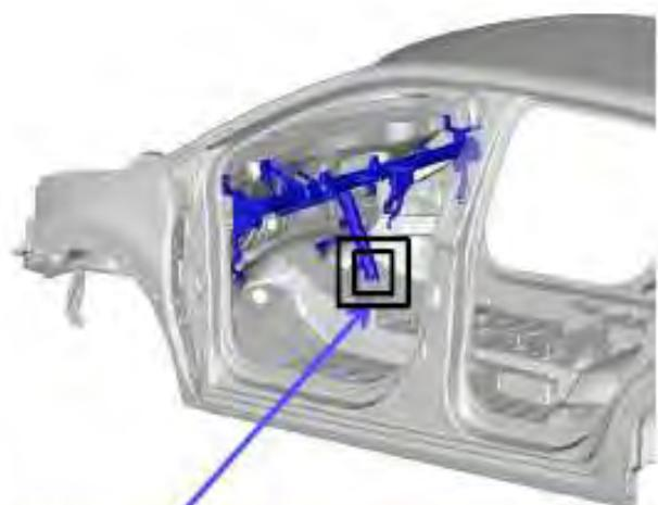
Abstützung: unter der Mittelkonsole; diese Stütze muss zum Wegklappen des Frontmoduls durchtrennt werden.
